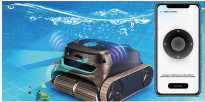
Grâce à une communication sous-marine par ultrasons, le Wybot S2 Pro peut être télécommandé avec une précision remarquable directement depuis un smartphone.
