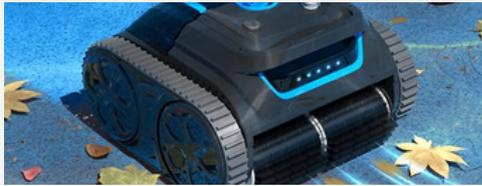
Grâce à ses 3 moteurs performants, 2 brosses rotatives et une large bouche d'aspiration, le Wybot S1 est conçu pour éliminer efficacement les feuilles, la poussière et les débris.
